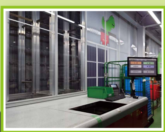
貨物をコンテナに格納・取出しするワークステーション ここで全ての作業を行えるので、歩行レスピッキングが実現！
